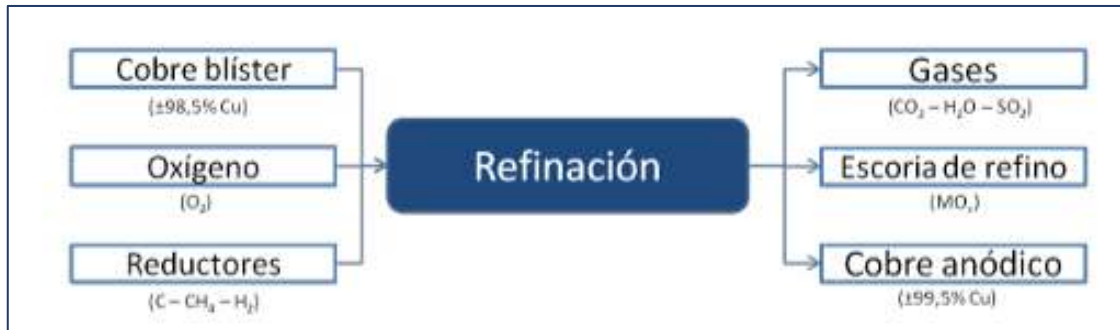
Figura 12. Esquema de insumos y productos del proceso de refinación de cobre blíster. Fuente: (COCHILCO, 2015, p.).
