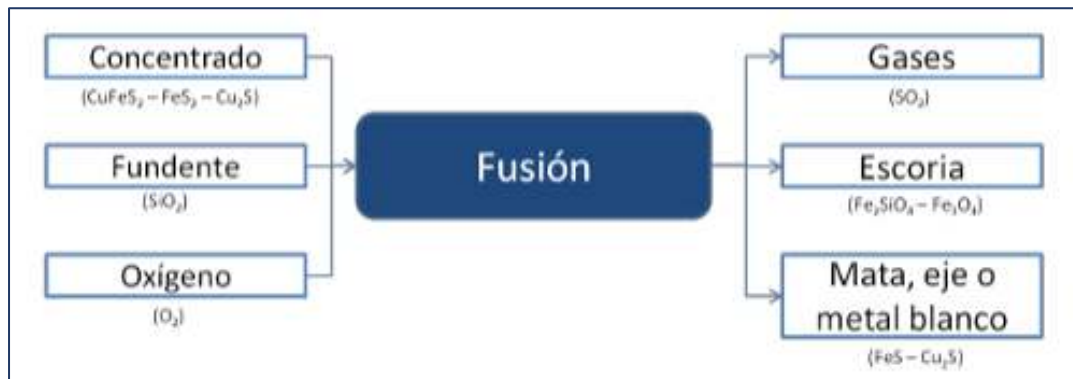
Figura 10. Esquema de insumos y productos del proceso de fusión de concentrados de cobre.
