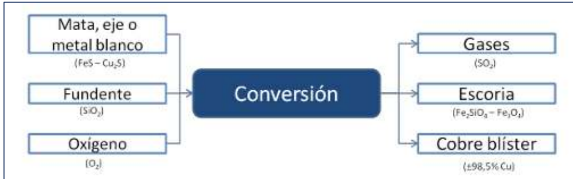
Figura 11. Esquema de insumos y productos del proceso de conversión de mata de cobre. Fuente: (COCHILCO, 2015, p.).
