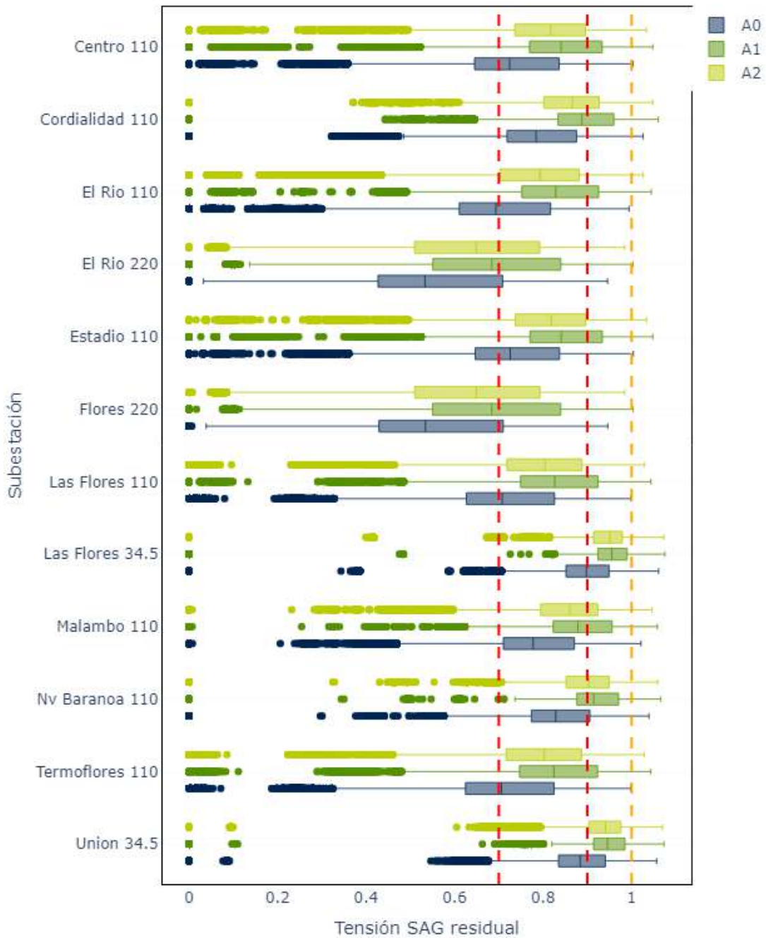
Figura 3.1.3-44 Comparación de las tensiones residuales del SAG entre el caso base A0 y el caso con el proyecto Compensadores Síncronos Área Caribe A1-A2 – Subárea Atlántico – Parte 2.
