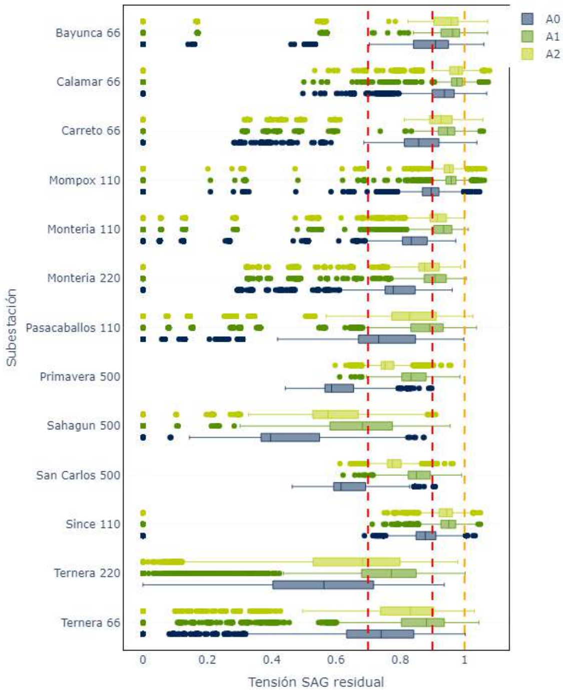
Figura 3.1.3-49 Comparación de las tensiones residuales del SAG entre el caso base A0 y el caso con el proyecto Compensadores Síncronos Área Caribe A1-A2 – Subárea Bolívar, Córdoba-Sucre – Parte 3.
