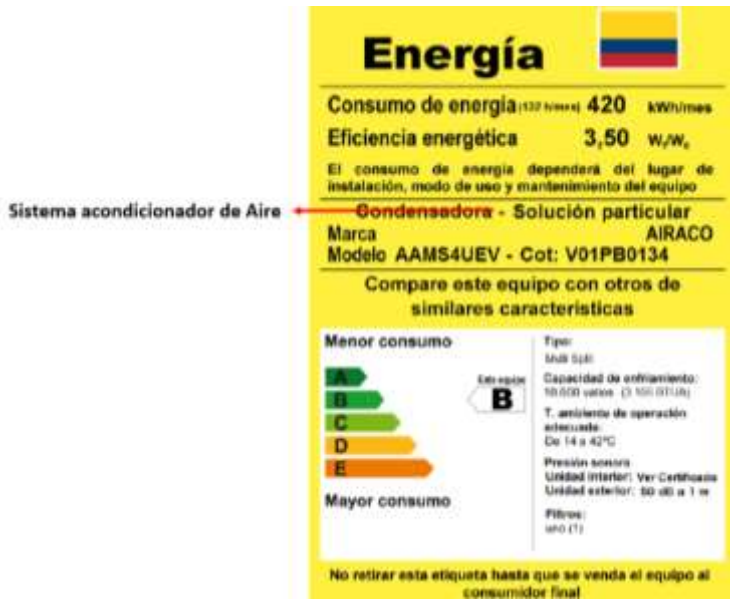
Figura 8.5 c. Ejemplo de etiqueta para solución particular de acondicionamiento de aire con sistema de múltiple salida”
