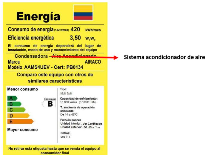
Figura 8.5 b. Ejemplo de etiqueta para modelo genérico de Condensadora de sistema de múltiple salida”
