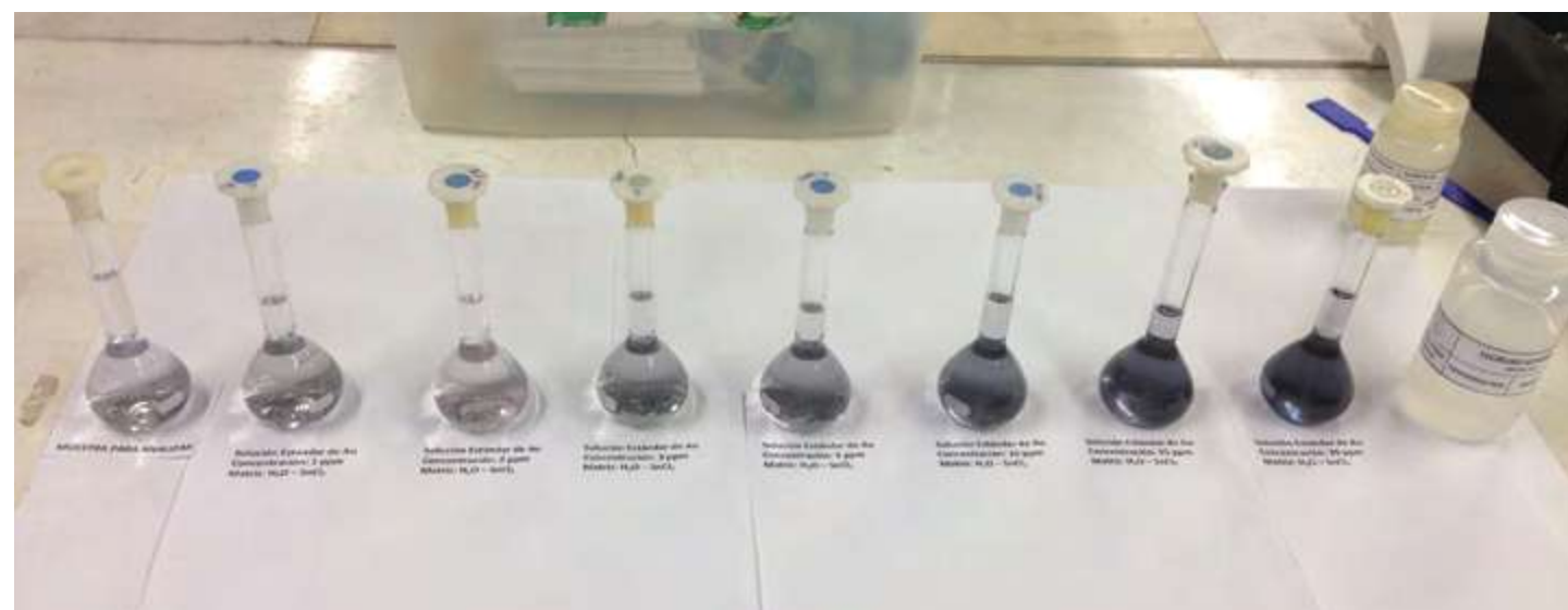
Fotografía 17: Curva de calibración para el análisis de oro por colorimetría, posterior a medición en el equipo UV Vis. Fuente: Propia.
