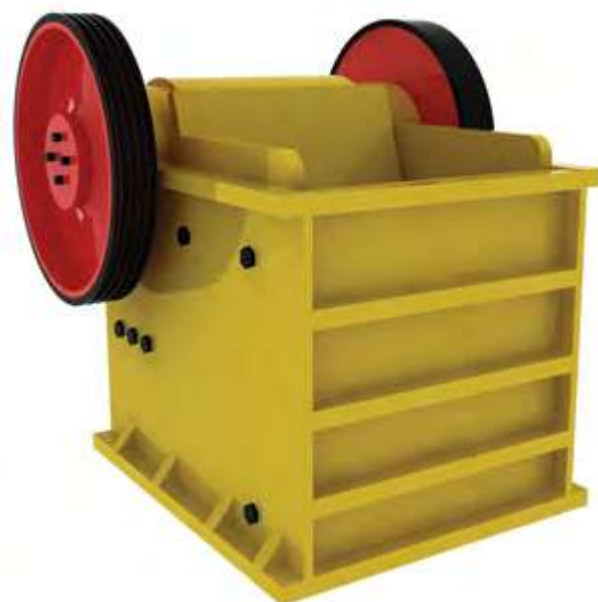
Fotografía 5: Modelo de trituradora de quijadas. Fuente: Propia.
