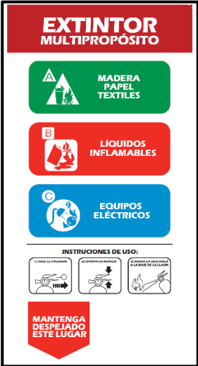
Ilustración 11. Ejemplo de rotulación de extintores
