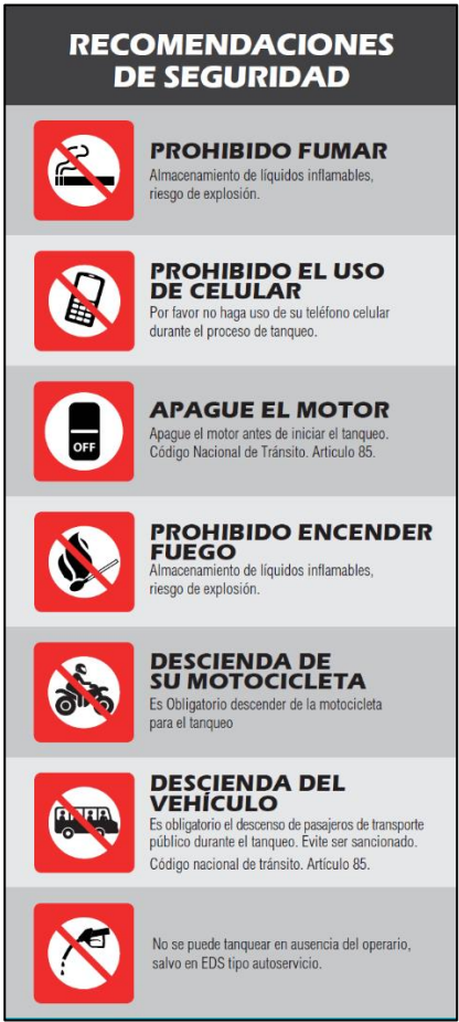
Ilustración 1. Ejemplo de rotulación para zona de abastecimiento
