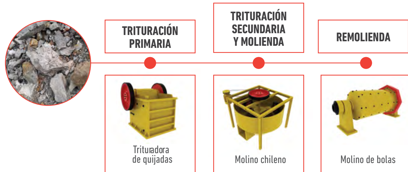
Figura 6.2. Diagrama de proceso de conminución (trituración y molienda). Fuente: autores.
