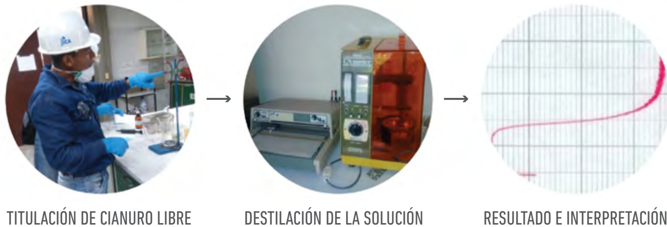
Figura 7.8. Proceso de titulación de cianuro libre y cianómetro utilizado en el laboratorio del SGC sede Cali. Fuente: autores.
