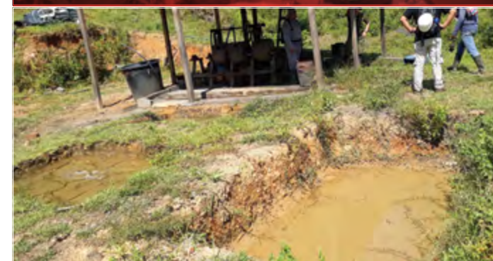
Fotografía 7.8. Entable La Ceiba con sus pocetas de vertimientos. Fuente: autores.
