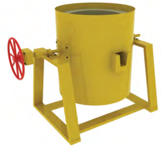
Fotografía 6.12. Modelo de horno con crisol. Fuente: autores.
