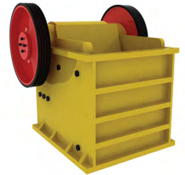
Fotografía 6.1. Modelo de trituradora de quijadas. Fuente: autores.
