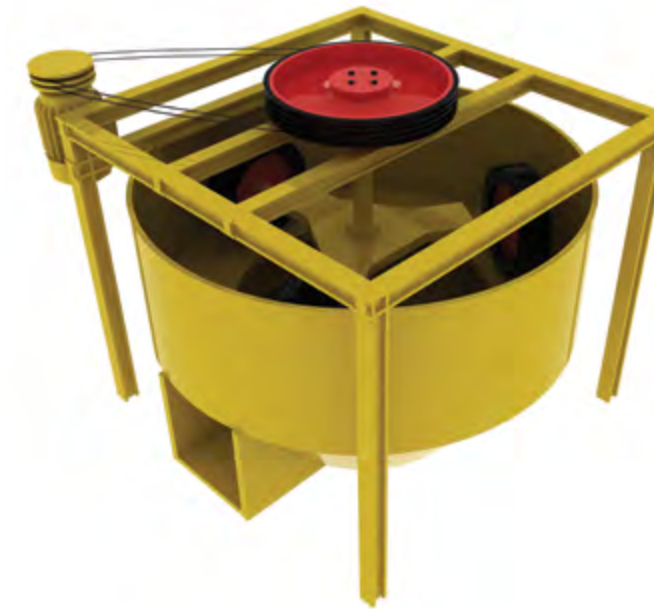
Fotografía 6.3. Modelo de un molino chileno. Fuente: autores.
