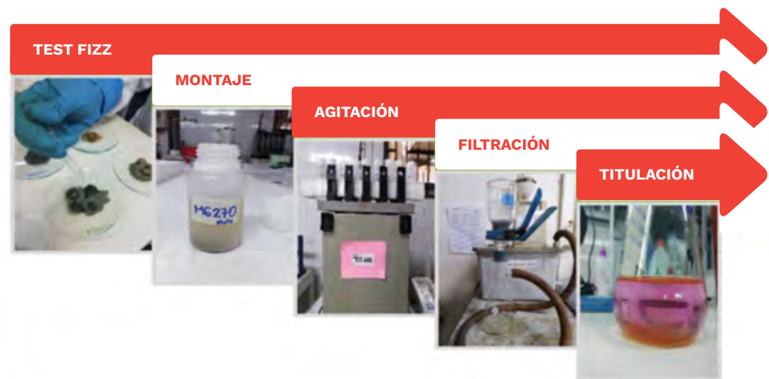
Figura 7.26. Procedimiento Test ABA Modificado. Fuente: autores.
