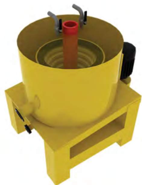
Fotografía 6.9. Modelo de un concentrador centrífugo. Fuente: autores.
