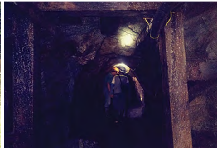
Fotografía 5.4. Combinación de sostenimiento natural y artificial con puertas alemanas. Fuente: autores.
