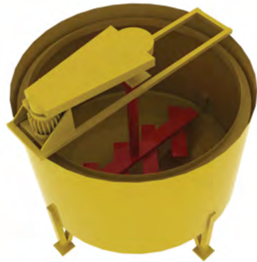
Fotografía 6.13. Modelo de tanque espesador. Fuente: autores.
