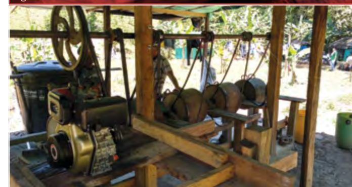
Fotografía 7.4. Molinos de cocos en el entable el Hundidor. Fuente: autores.
