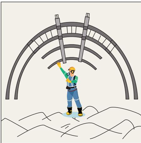
**B. Subir las dos secciones que conforman la corona y armarlas dejando un traslape de 40 cm e instalar y asegurar las grapas en cada lado del traslape.**
