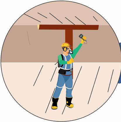
B. Mida gases, inspeccione el área y desabombe desde un área segura.
