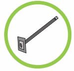
F. Introduzca el cartucho de cemento o resina y el extremo del perno con la cuña en el barreno, empújelo hasta que la cuña toque el fondo del barreno.
