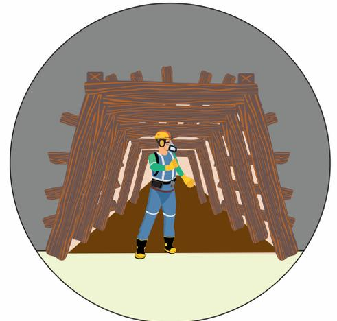
D. Realice medición de gases y desabombe de una forma adecuada y desde zona segura
