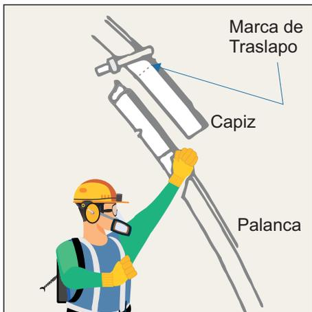
**I. Se debe llevar el otro extremo de la palanca hasta coincidir con la marca del cápiz y ajustar la grapa.**
