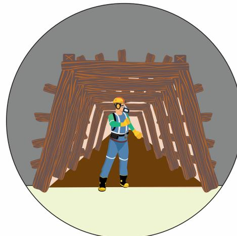
D. Realice medición de gases y desabombe de una forma adecuada y desde zona segura
